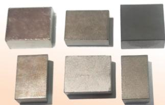
Ограниченная номенклатура напайных пластин для дисковых пил на операциях резки муфтовых заготовок. Освоение новых типоразмеров продолжается.
